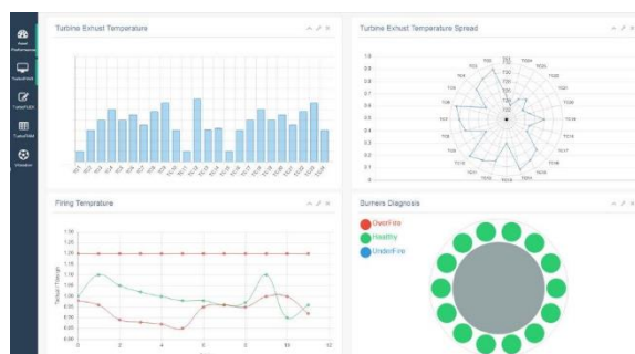
شکل ۱۲: نمایی از نتایج کد تشخیص برنر معیوب محفظه فریم ۹
