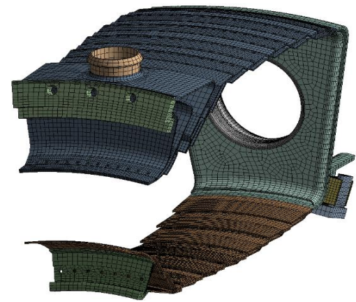
شکل ۹: نمایی از شبکه‌بندی محفظه احتراق نسل سوم IGT25
