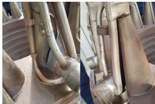
شکل ۳: نمونه‌ای از رشد ترک در برنر محافظه احتراق IGT25 کارکرده
