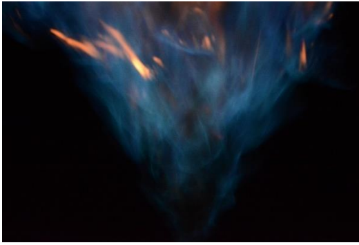
شکل ۱۶: تصویر مربوط به شعله آبی رنگ با حساسیت مناسب تصویر برداری (ISO6400) برای این شعله
