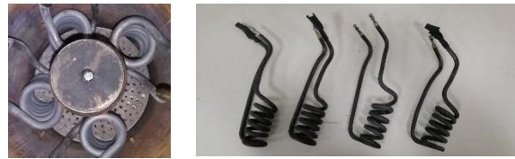
شکل ۱: تصاویر مربوط به المنت های حرارتی و نحوه قرار گیری آنها بر روی آزمونگر
