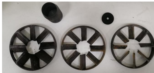
شکل ۴: تصاویر مربوط به پیچاننده‌های هوا به ترتیب از سمت راست با اعداد پیچش ۰,۴، ۰,۶ و ۰,۸ به همراه پایه و صفحه پوشاننده پایه پیچاننده هوا
