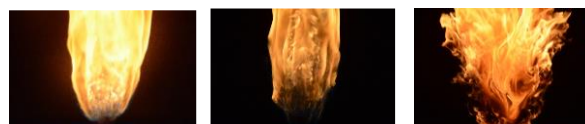
شکل ۷: مقایسه برخاستگی شعله برای شعله در شرایط بدون پیچش (سمت چپ)، دارای پیچش در دبی های هوای جانبی میانی (وسط) و دارای پیچش در دبی های بالای هوای جانبی (سمت راست)
