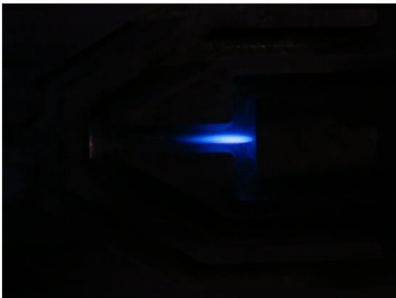
شکل ۴: نمایشی از شعله احتراق میکرو در نسبت هم‌ارزی ۱/۶۹
