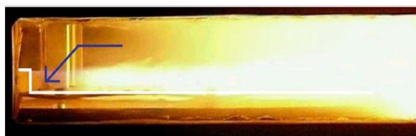
شکل ۵: عدم وجود شعله در ناحیه گردش مجدد پس از اشتعال (همانطور که با فلش نشان داده شده است).
