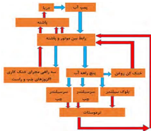
شکل ۵: مدار خنک‌کاری بازطراحی موتور ارتقاء یافته در پژوهش باری و همکاران [۷]
