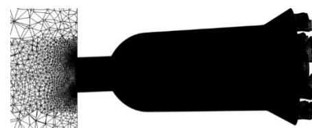
شکل ۶: شبکه بندی دامنه محاسباتی مشعل قبل از تغییر هندسه (الف) نمای کلی (ب) برش از صفحه میانی محل اتصال مشعل به کوره
