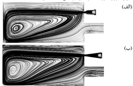
شکل ۱۲: خطوط جریان چرخش محصولات احتراق درون مشعل و کوره (الف) هندسه اولیه مشعل (ب) پس از تغییر هندسه مشعل
