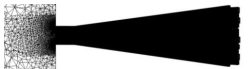
شکل ۷: شبکه بندی دامنه محاسباتی مشعل بعد از تغییر هندسه (الف) نمای کلی (ب) برش از صفحه میانی محل اتصال مشعل به کوره
