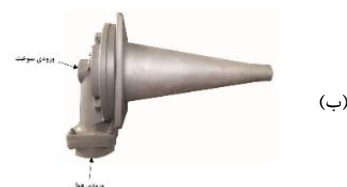
شکل ۱: هندسه مشعل (الف) قبل از تغییر (ب) بعد از تغییر [۶]
