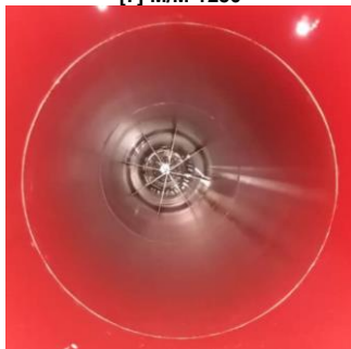
شکل ۱۱- نمایی از مستقیم کننده جریان ستاره ای نصب شده داخل تونل باد
