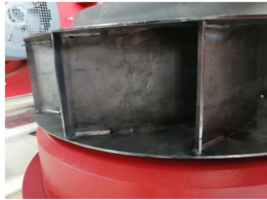
شکل ۲۲- خم ایجاد شده در لبه انتهایی فن شماره ۱۱ و ایجاد یک پره فوروارد- بکوارد
