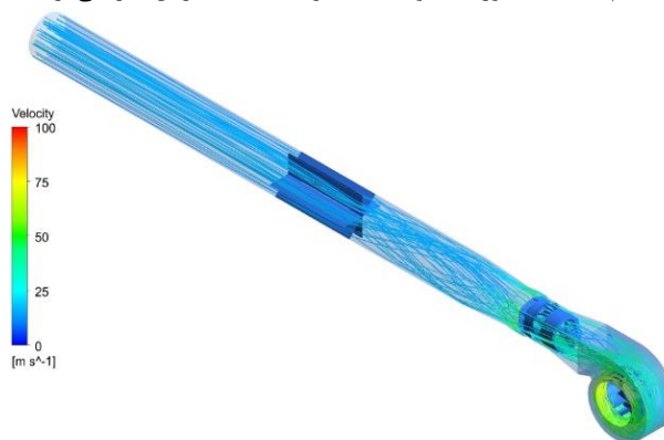
شکل ۱۴- خطوط جریان در گذر از تونل باد و مستقیم کننده جریان
