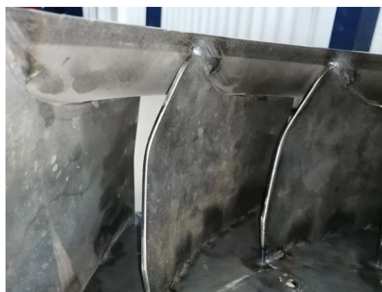
شکل ۱۸- تغییر شکل پره‌های فن شماره ۹ پس از افزایش دور موتور تا ۳۵۰۰ دور
