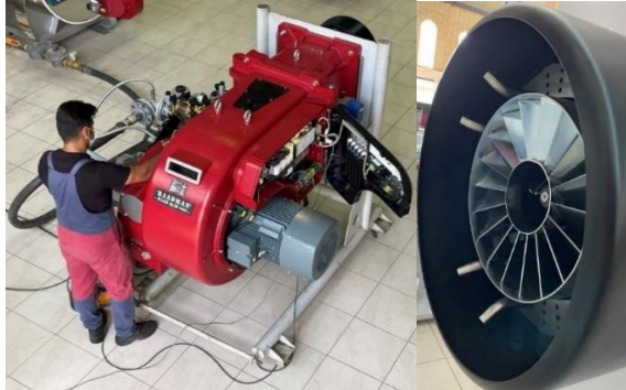
شکل ۳۵: سری مشعل با طول شعله کوتاه، قابل نصب بر روی بدنه‌های مونوبلاک یا دوآل بلاک، تولید شرکت پاکمن
