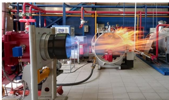
شکل ۳۷: شعله‌ی مشعل شعله کشیده، در ساختار مونو بلاک، در مرحله تست تجربی، در حالت ظرفیت کمینه تولید شرکت پاکمن
